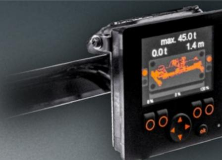
Perfekt angeordnet für schnelles Erfassen sind die drei Displays: Das Haupt-Display mit allen Maschinen- und Leistungsdaten ist in der Konsole integriert. Das Head-up-Display mit den Informationen zum Greifer befindet sich an der Vorderkante des Dachglases, liegt somit beim Positionieren des Spreaders in der direkten Blickrichtung des Fahrers, und das Display für die Rückfahrkamera ist auf der linken Konsolenseite untergebracht.
